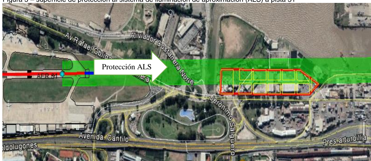
Figura 5 – superficie de protección al sistema de iluminación de aproximación (ALS) a pista 31
